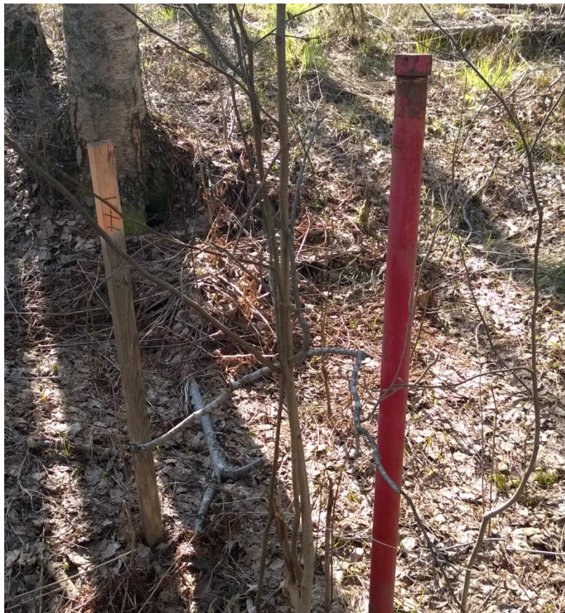
Kuva 2 Pettilän pohjavesitutkimuksessa asennettu pohjavesiputki P9.
